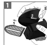
Pour assembler le support de tasse avec le bac d'égouttage: enlevez la grille, placez les l'un contre l'autre. Clipez le bac d'égouttage dans l'encoche du support de tasse.
