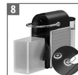
Presione el botón Lungo y espere hasta que se vacíe el depósito de agua.
