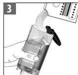
Llene el depósito de agua con 0.5 L de agua y agregue el líquido descalcificante *Nespresso*.
