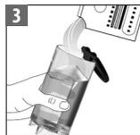
Remplissez le réservoir d'eau de 0.5 L/16.9 fl oz d'eau et ajoutez le liquide de détartrage *Nespresso*.
