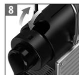
Retire la taza. Levante y cierre la palanca para expulsar la cápsula caera en el contenedor de cápsulas usadas.
