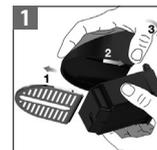
Para ensamblar el soporte para tazas y la bandeja de goteo: retire la rejilla, colóquelos uno al lado del otro y coloque la bandeja de goteo en el soporte para tazas.
