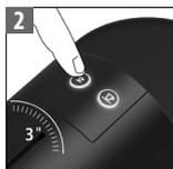
Con la máquina apagada, presione y mantenga el botón Espresso por 3 segundos. El botón Espresso parpadeará para indicar los ajustes actuales.
